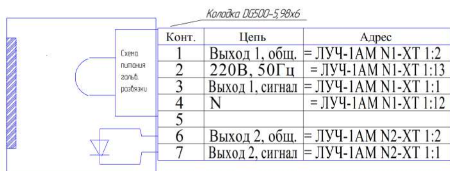
Рис.8. Выходные электрические цепи фотодатчика ФД-05ГМ.
